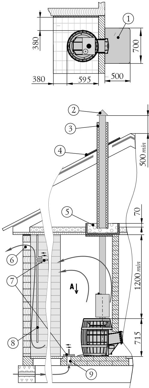
металлический лист по теплоизоляционному материалу (асбестовому картону толщиной 10мм)
