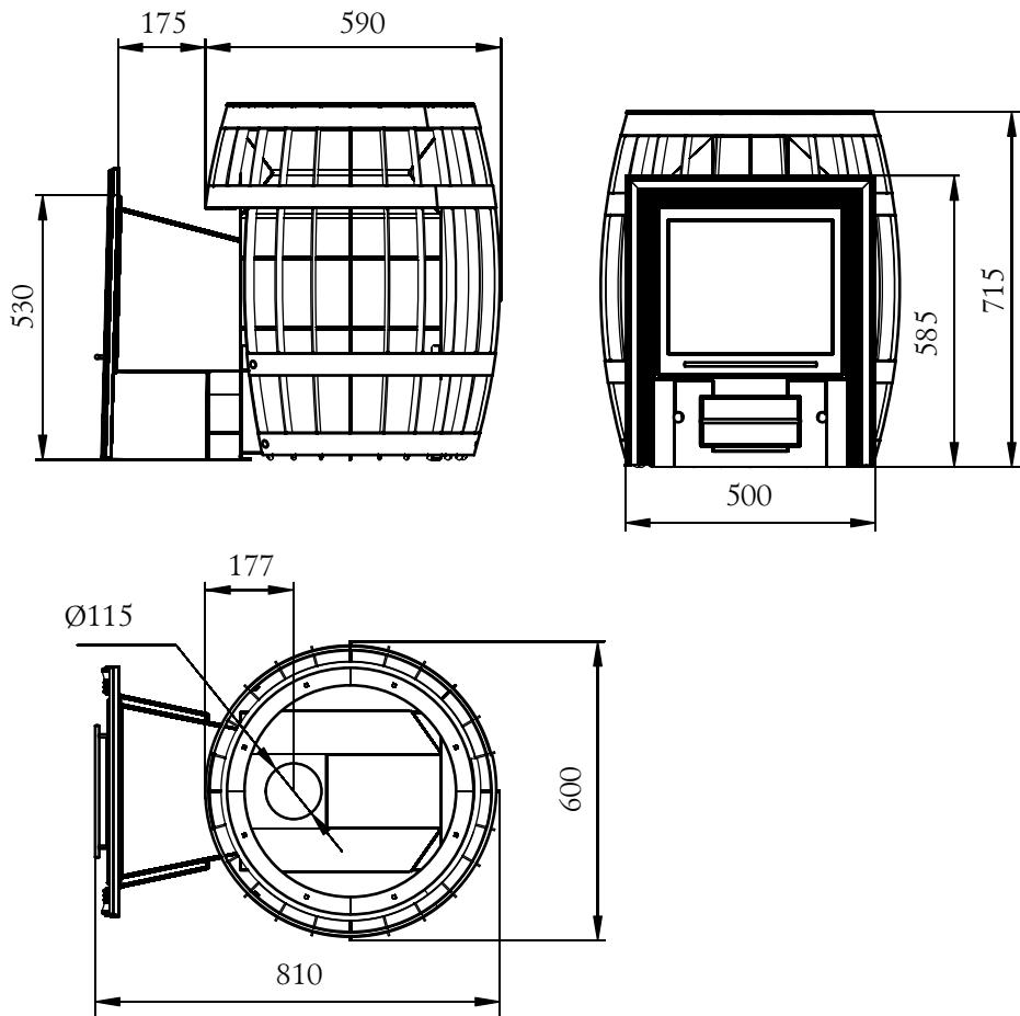
Рисунок 1. Габаритные размеры печи «Саяны Витра».
