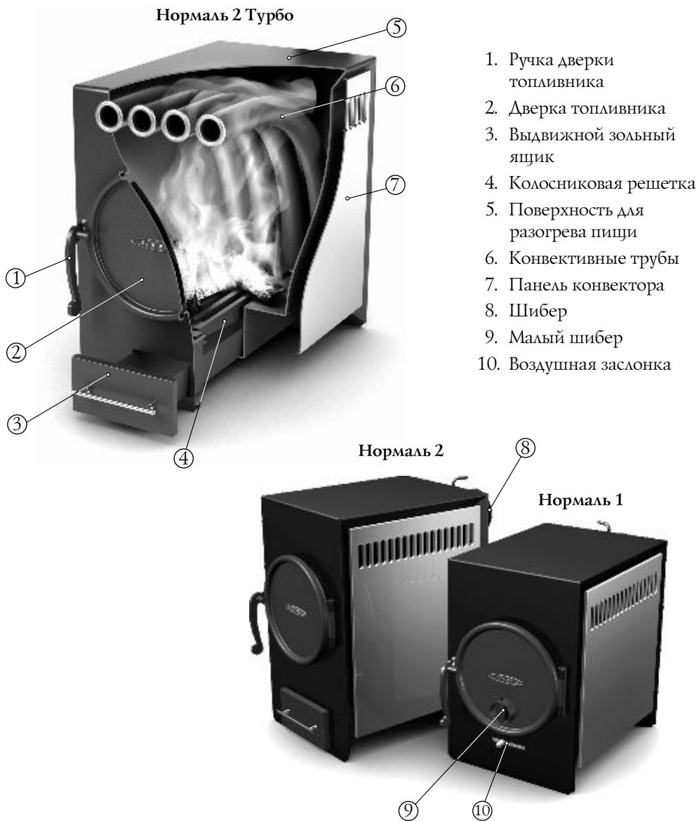
Рисунок 2. Расположение основных элементов печи «Нормаль».
