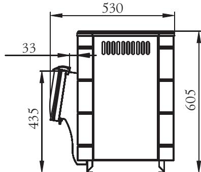
Рисунок 2. Габаритные размеры печи «Оса» с коротким топливным каналом.
