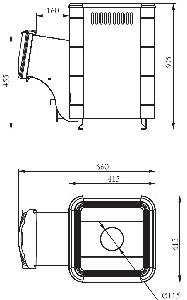
Рисунок 1. Габаритные размеры печи «Оса».
