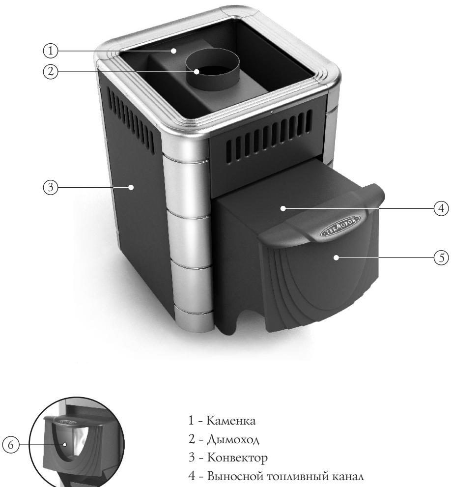
Рисунок 3. Расположение основных элементов печи «Оса».
