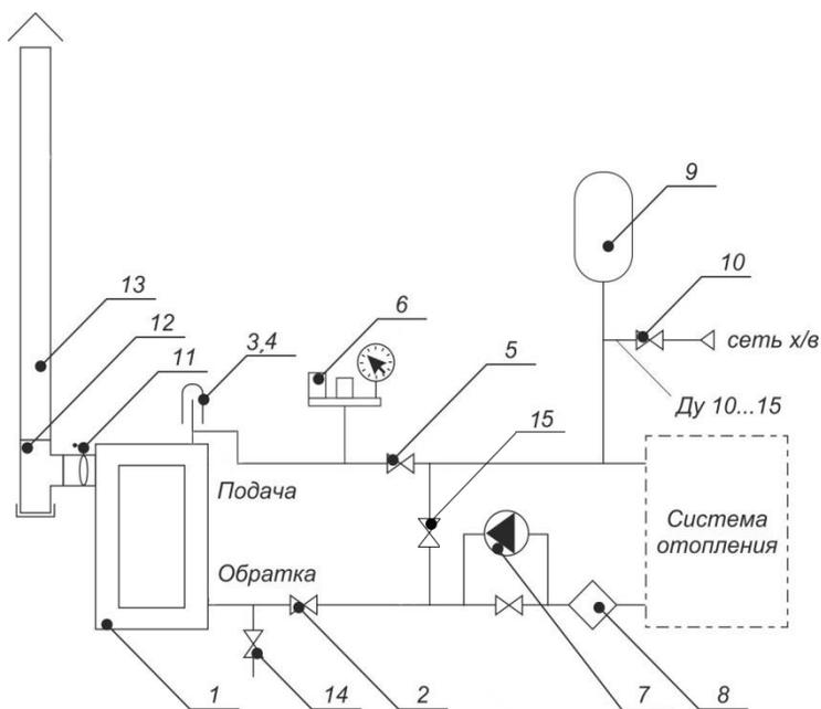
Рис.4 Пример схемы подключения котла к системе с конвективной самоточной циркуляцией теплоносителя.
